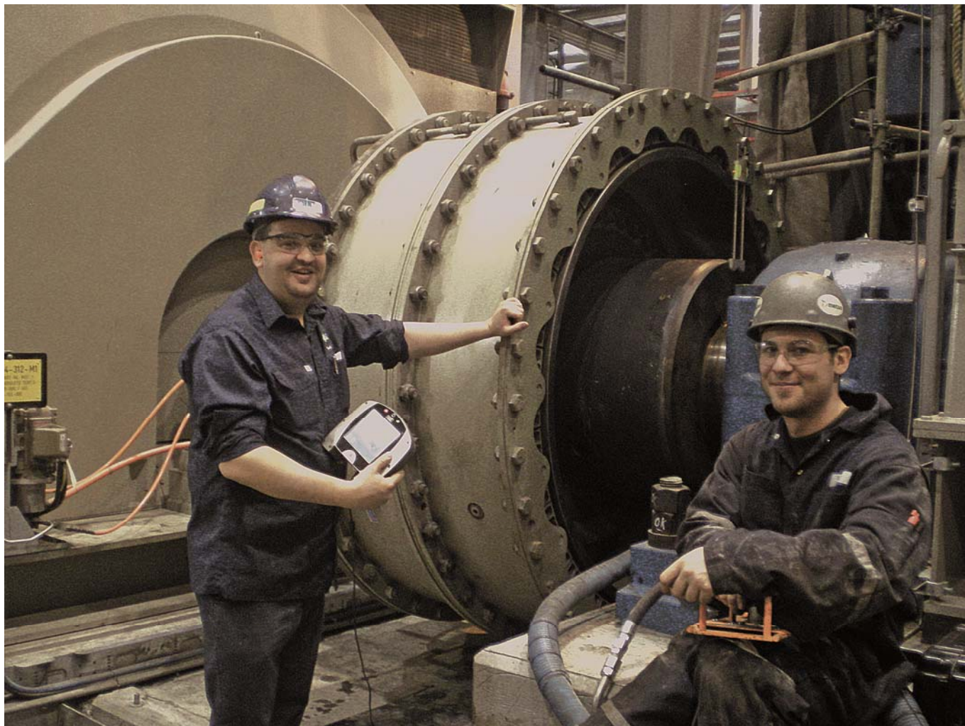
Bild: Axeluppriktning av malmkross med en kopplingsdiameter på 2 meter.
